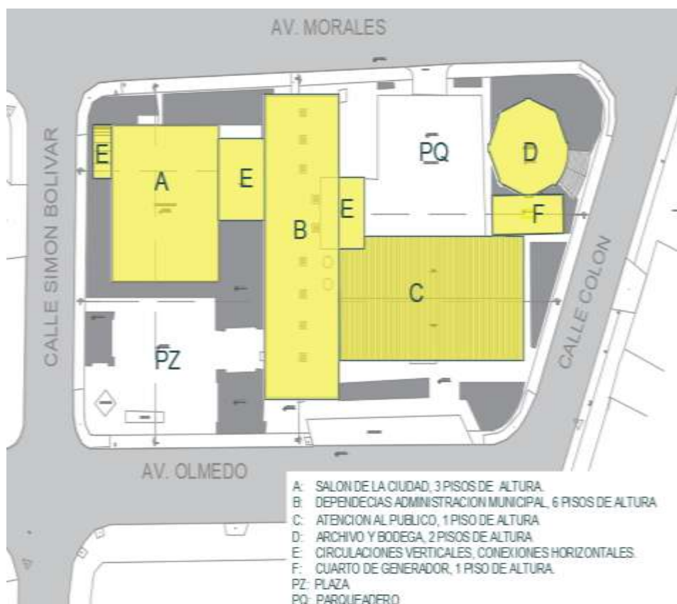
Ilustración 5: Edificio original, composición en planta.
