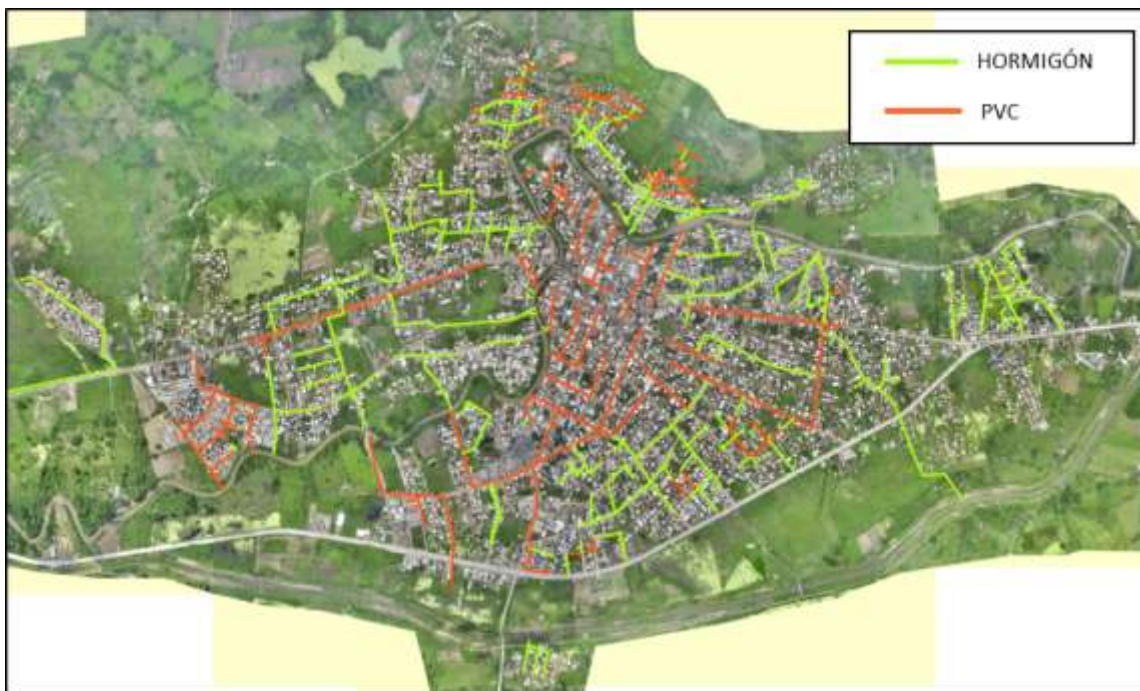
Ilustración 5 Infraestructura de alcantarillado pluvial existente por material.
