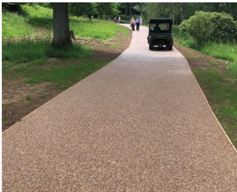
Ilustración 19: Pavimento drenante para evitar inundaciones. Fuente: Parque Benicalap, Valencia / Téseris, España
