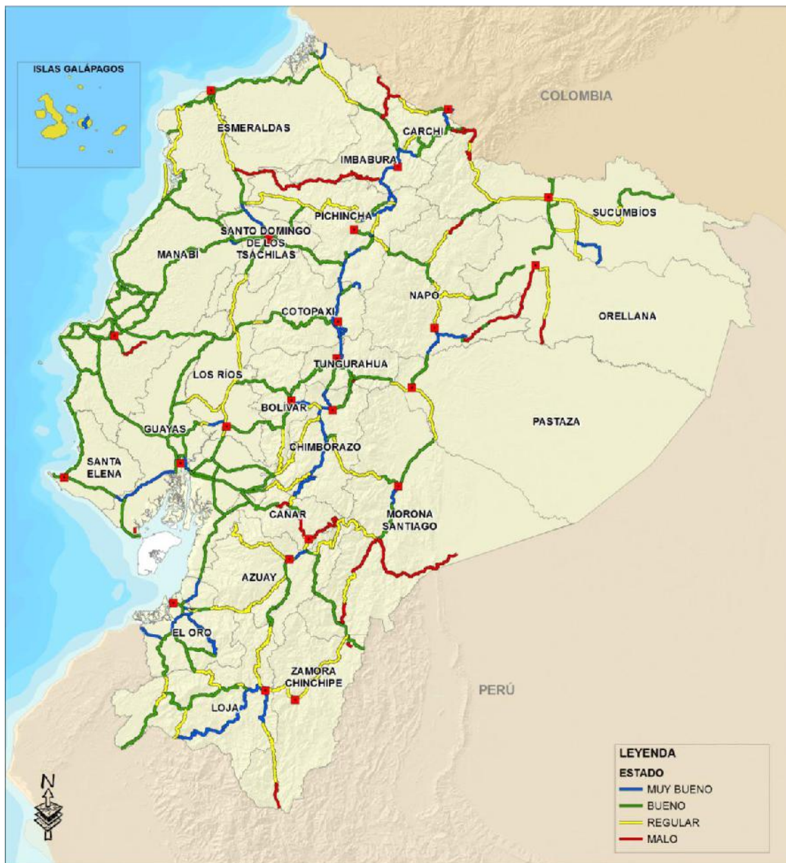
Ilustración 2: Estado de la Red Vial Estatal
